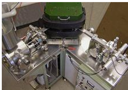
Espectrómetro de masas de ionización térmica utilizado en la datación radiométrica
